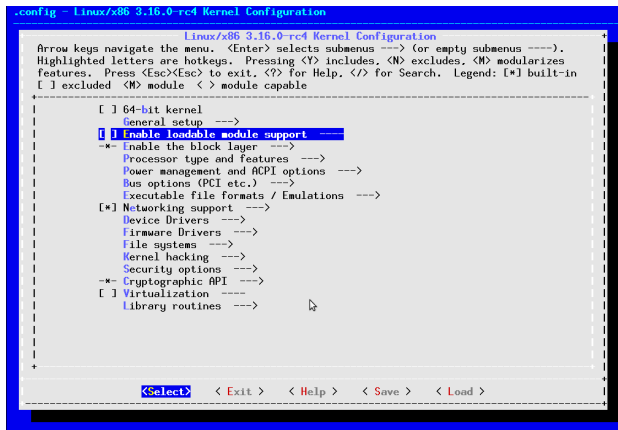
Abbildung 1: Module in der Linux-Kernel-Konfiguration ausschalten
