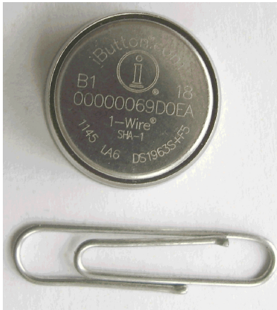
Abbildung 9: iButton von Maxim mit SHA-1-Logik
