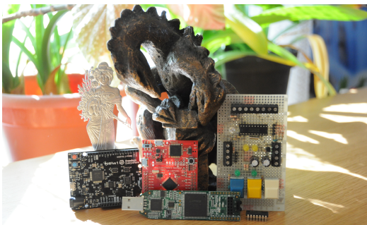
Abbildung 2: Swap inmitten von Forth-Geschichte: HiFive1 (Mecrisp-Quintus), Stellaris Launchpad (Mecrisp-Stellaris), Icestick (Mecrisp-Ice), meine Ausprobierplatine für den MSP430G2553 (Mecrisp) und schließlich, ganz klein in der Ecke: Ein MSP430F2012 (Mecrisp-Across).
