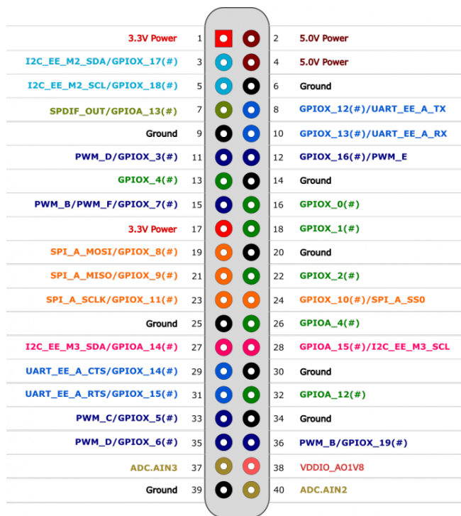
Abbildung 2: GPIO-Leiste des Odroid N2+ [2]
