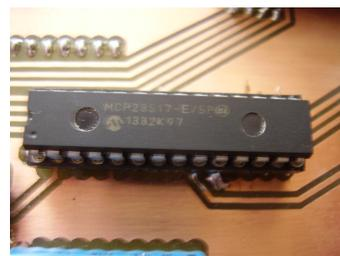
Abbildung 8: MCP23S17, eine serielle Porterweiterung
