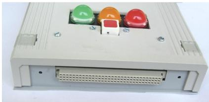
Abbildung 1: Kabeltester mit 64pol. Buchse
