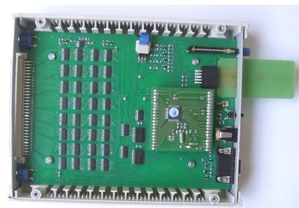
Abbildung 10: Innenansicht des Kabeltesters V1.0. Quadratische Platine rechts in der Bildmitte: SBC mit nano-FORTH auf GP32. Rechts oben gesteckt: Datenträger mit seriellen EEPROMs. Links das Array aus 74HC4051 Multiplexern, um die Leitungen zu messen.
